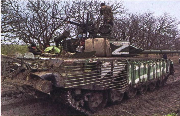
Der Kampfpanzer T-72B4 verfügt über seitliche Zusatzpanzerungen.
