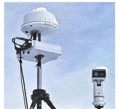
▲ SecuriDrone Drohnendetektionssystem für Blaulichorganisationen.
