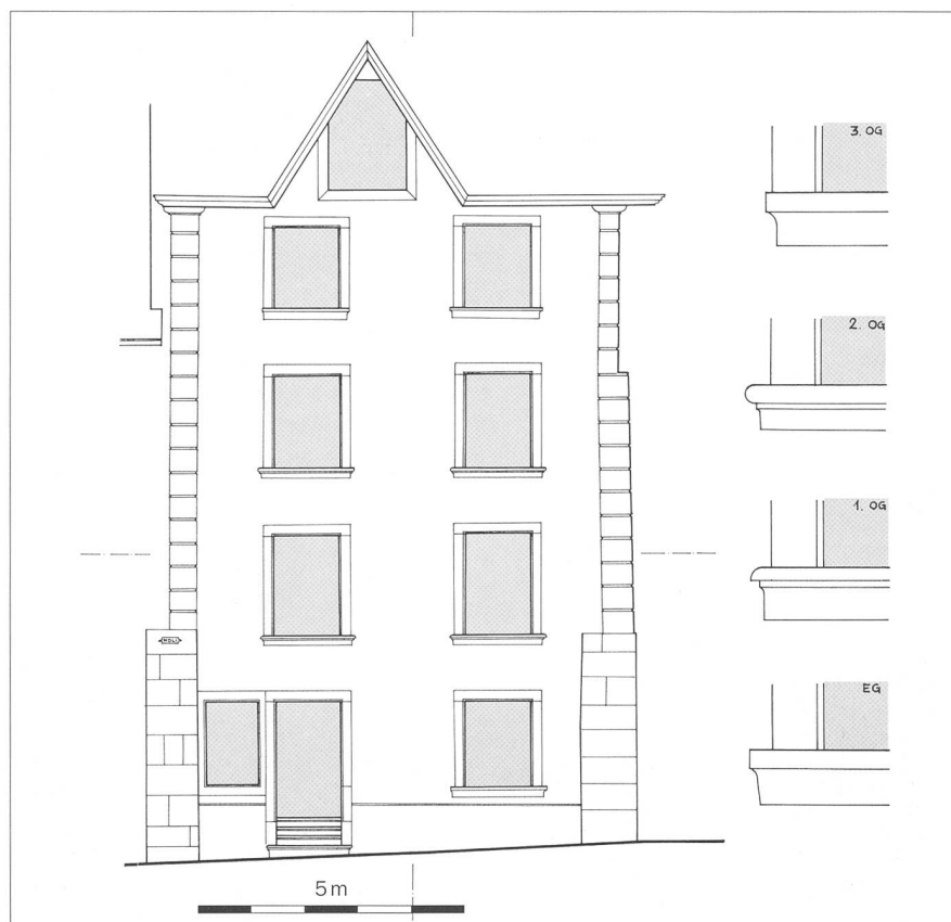
Abb. 2 Ostfassade an der Pfisterngasse, Planaufnahme mit Details der Simsprofile.
