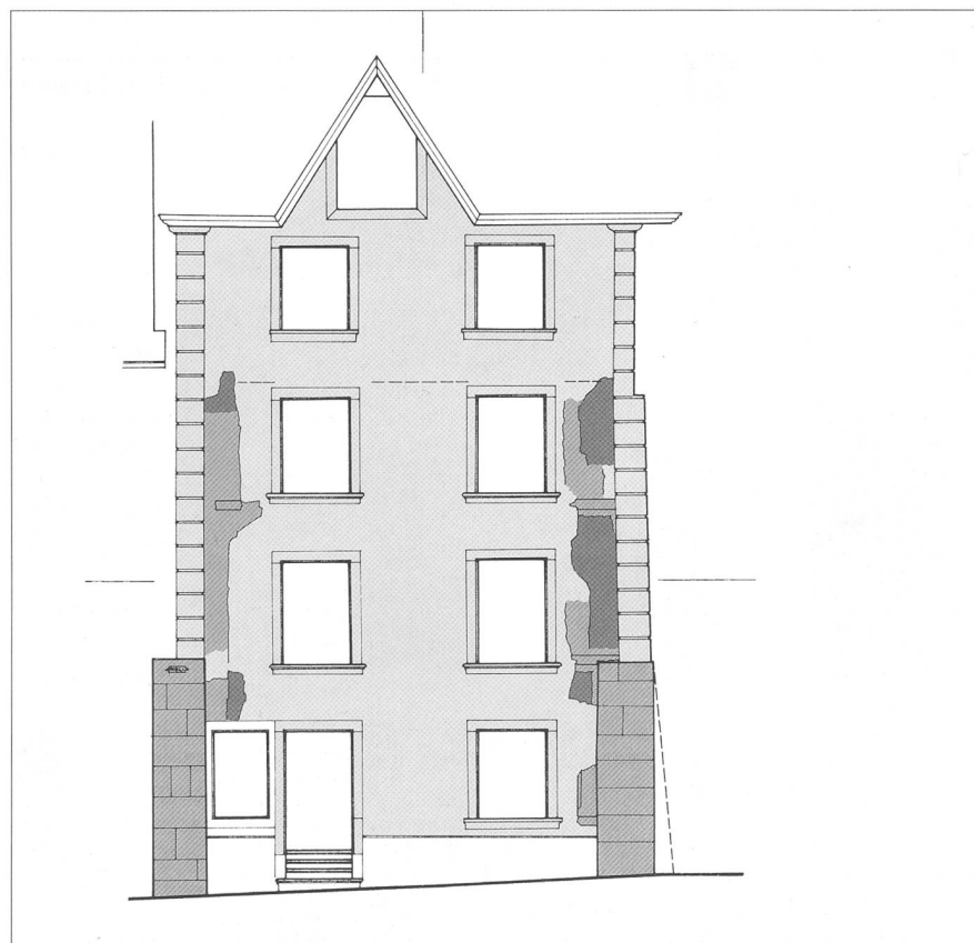
Abb. 3 Bauphasenplan der Ostfassade.
