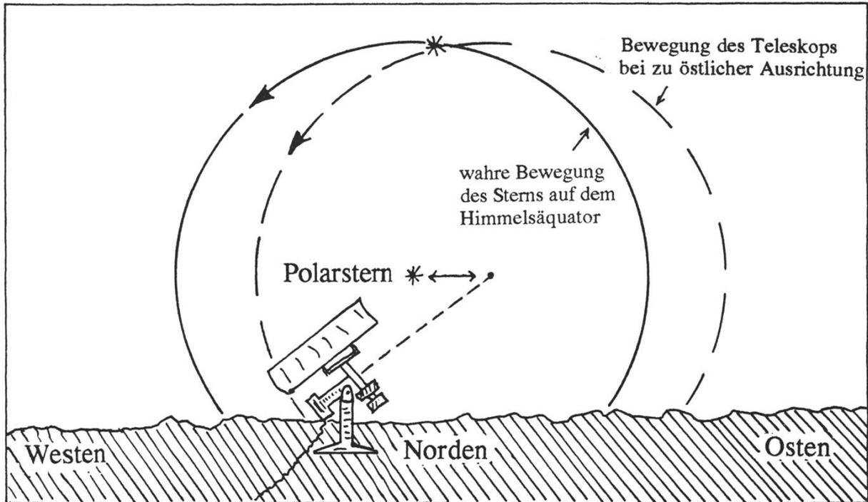
Abb. 1: Ost-West-Abweichung der Polachse.
