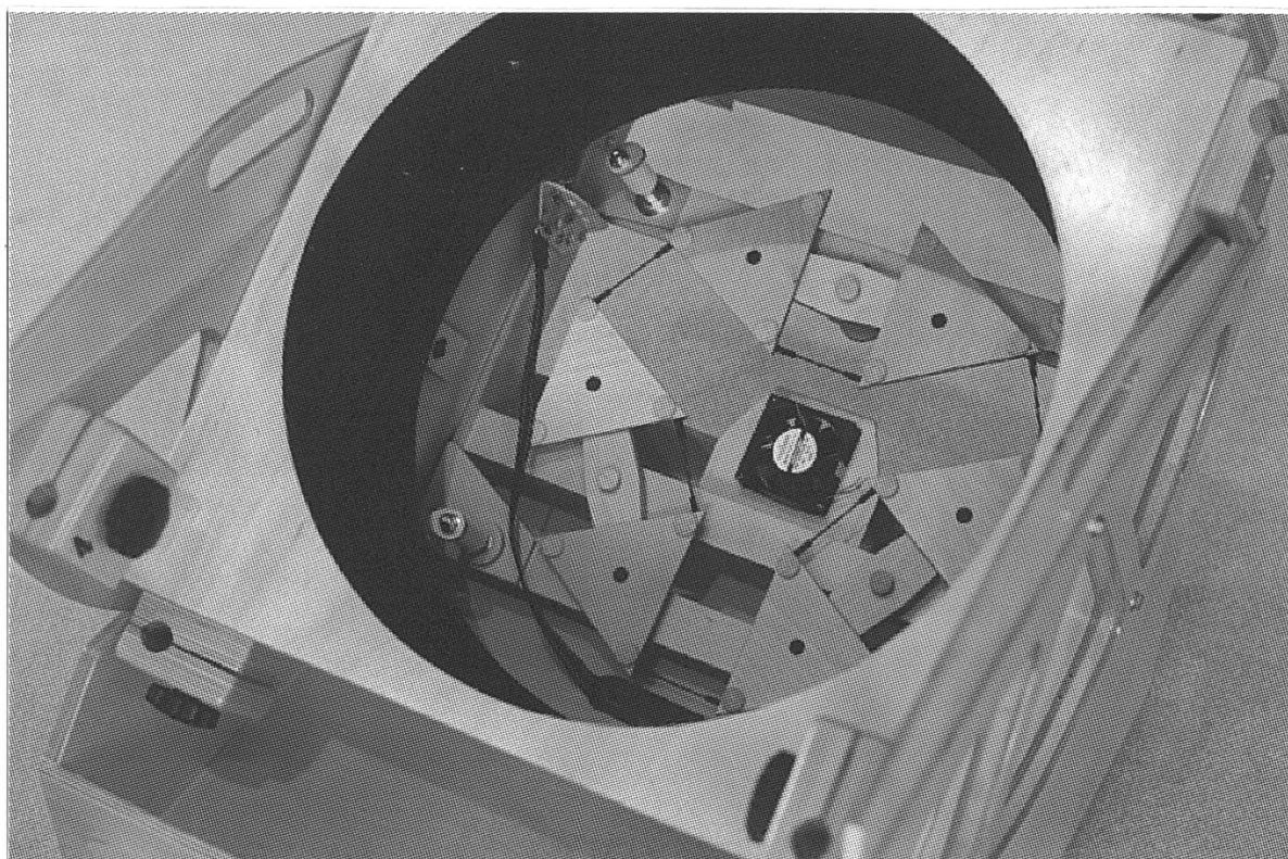
sperrholz mit einer 9 mm Zwischenlage aus Balsaholz. In den Spitzen des Dreiecks sitzen die Füße, bestehend aus 50 mm langen Resten der Tubusstangen, die 25 mm tief in das Brett eingelassen sind. Genau über den Füßen sind mittels doppelseitigem Klebeband die Lagerplättchen aus Teflon befestigt, Grösse ca. 1.5×20×30 mm.
