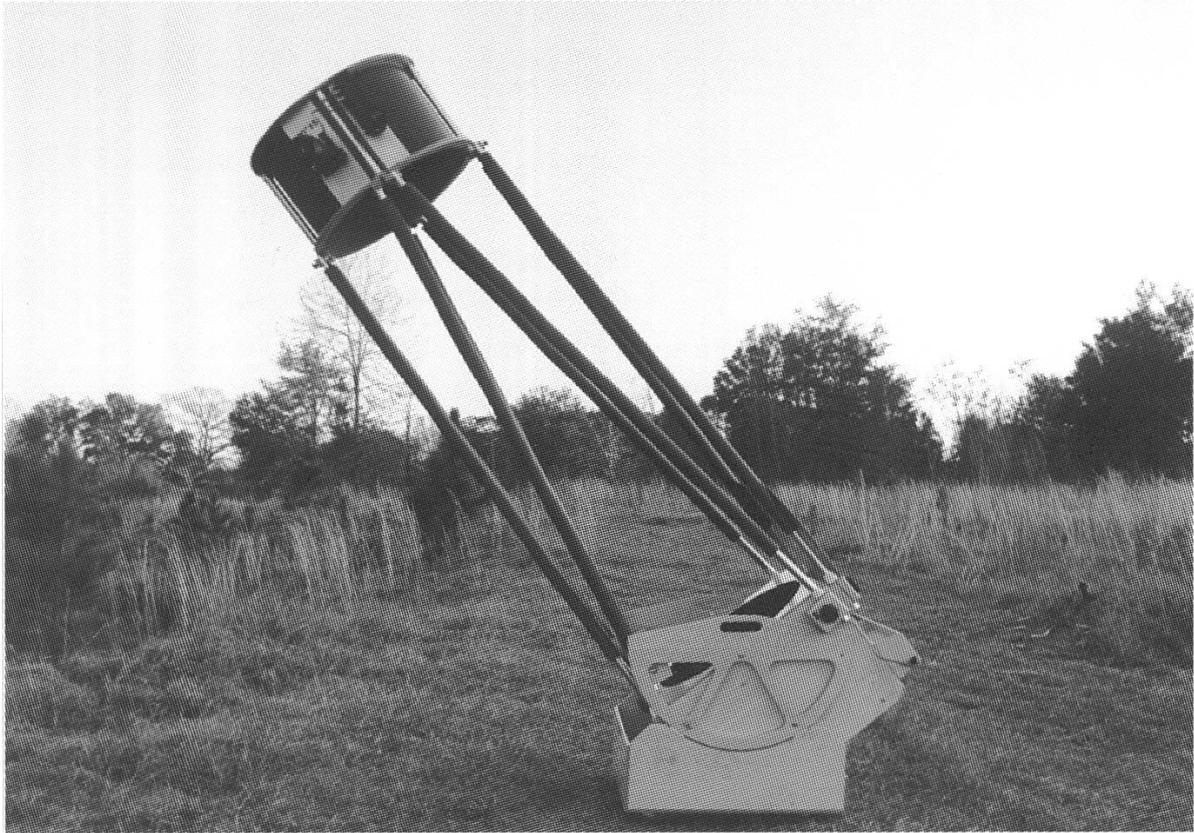
Möbelsperrholz gefertigt. Der untere Ring wird zusätzlich durch eine 3-mm-Lage Flugzeugsperrholz verstärkt.
