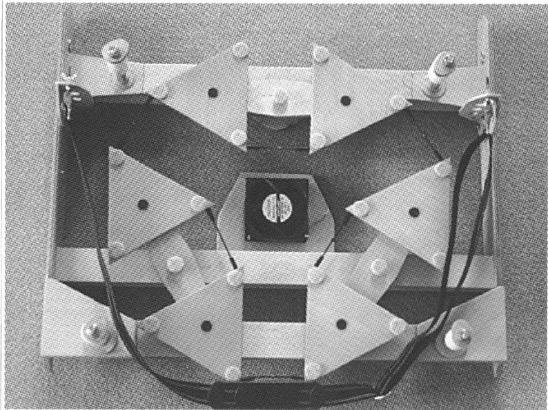
Im Betrieb, d.h. bei Neigung des Teleskops wird der Spiegel von einer Schlinge aus 25 mm breitem Gurtmaterial am halben Umfang getragen. Es geht auch ohne Schlinge, aber dann stützt sich der Spiegel gegen die unteren Kunststoffanschläge ab und liegt nicht mehr sauber auf den 18 Punkten auf. Gegen Herauskippen bei extremer Neigung ist der Spiegel durch vier kleine Sperrholznasen gesichert.
