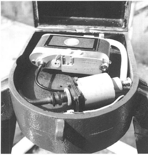
Abb. 4: Der Kamerakasten mit Kamera und der Magnetspule zum automatischen Bedienen des Verschlusses.
