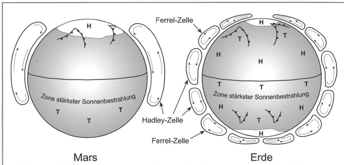
Abb. 1: Vergleich zwischen den Windzirkulationssystemen von Mars und Erde während des Nordsummerhalbjahres. Deutlich ist zu erkennen, dass die Hadley-Zellen auf der Erde gegenüber dem Äquator leicht nach Süden versetzt sind. Während Mars von einer einzigen Luftwalze überspannt wird, unterscheiden sich auf der Erde gleich mehrere Ausgleichsströmungen.
