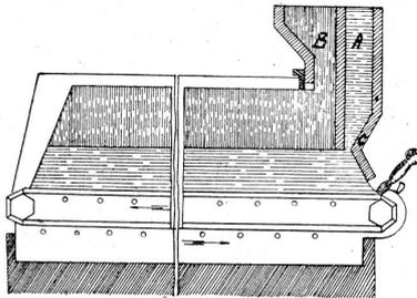
au combustible, sur cette préparation tombe de B une couche de débris de hourdis. La paroi C ne descend pas jusqu'à la grille de façon à laisser pénétrer dans le four la masse argileuse qui passe sur une flamme de gaz. Par l'aspiration des gaz à la partie supérieure du four ou par l'introduction d'air comprimé dans la partie inférieure, les scories sont séparées de telle façon qu'à la sortie on obtient des hourdis d'une cuisson irréprochable. Cet appareil a donné d'excellents résultats.
