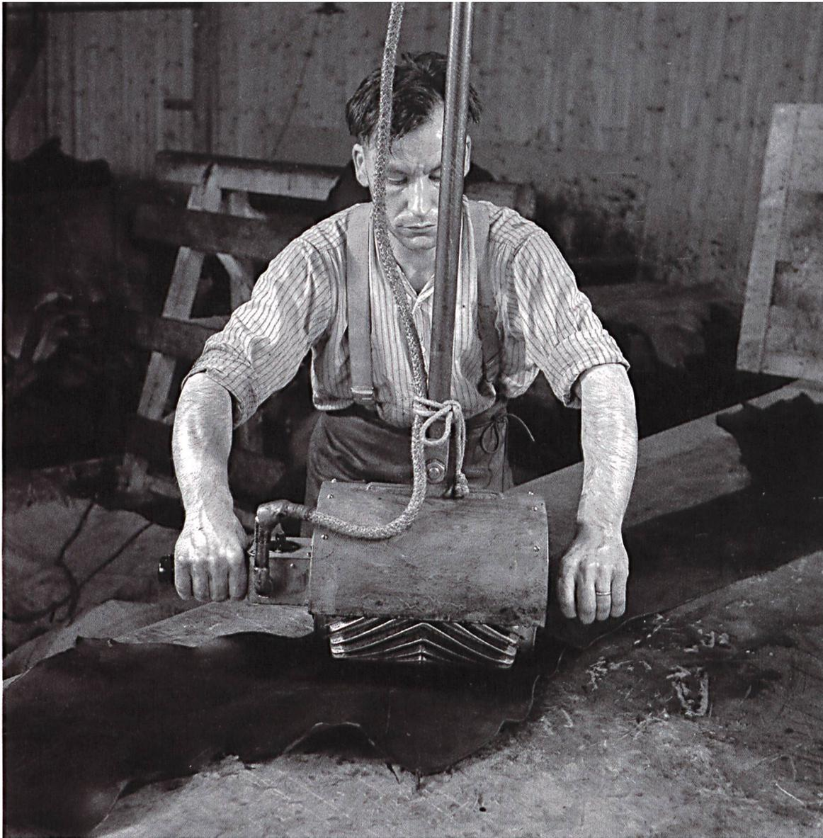
Ausrecken mit Maschine
