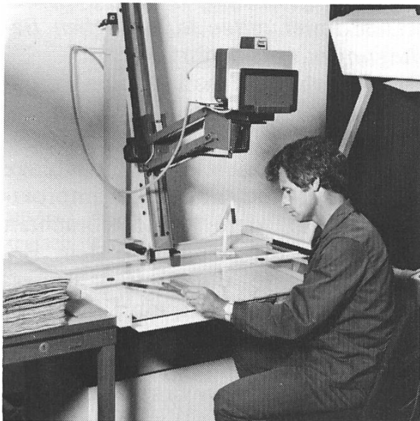
Bild 44. Eine Investition, die sich gelohnt hat: Aufnahmegerät des Staatsarchivs für Mikrofilme (35 mm - Rollfilm).
