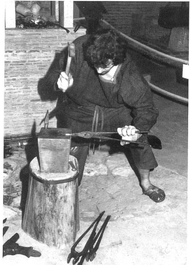
In der neuengerichteten Schmiede der fabrica im Römermuseum Augst bearbeitet der «römische» Schmied H. Ratsdorf am Amboss ein Stück Kanteisen. (Photos: Ursi Schild)
