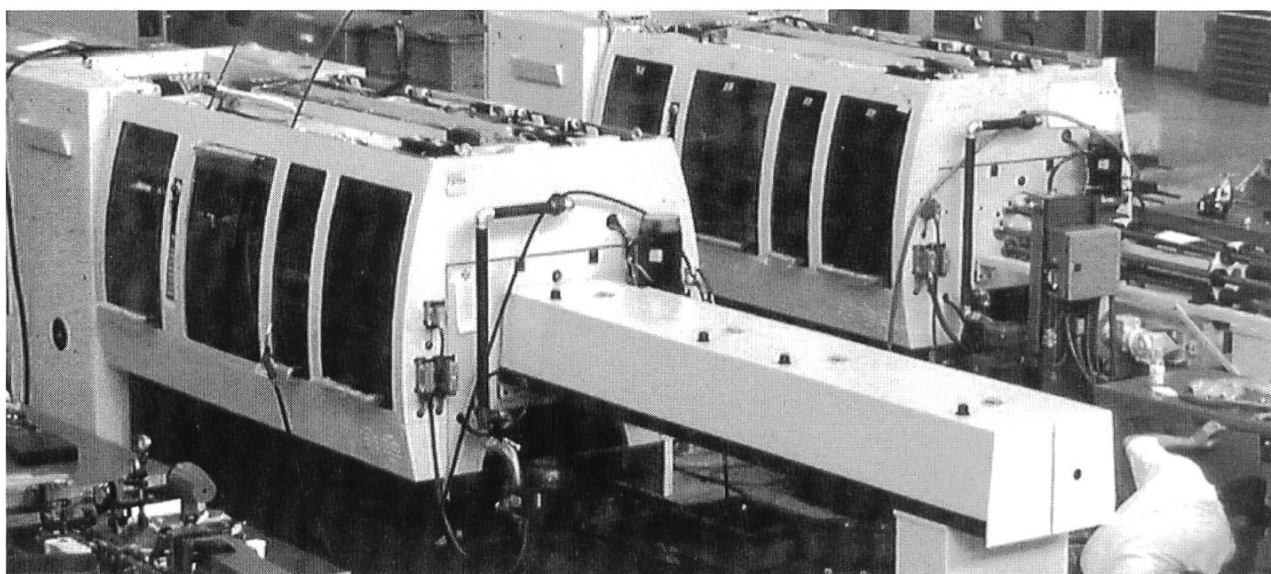
Abb. 14: Ein Drehautomat der neuesten Generation, mit automatischem Stangenwechsel von rechts. Ein aktuelles Produkt der Tornos-Bechler SA Moutier.
