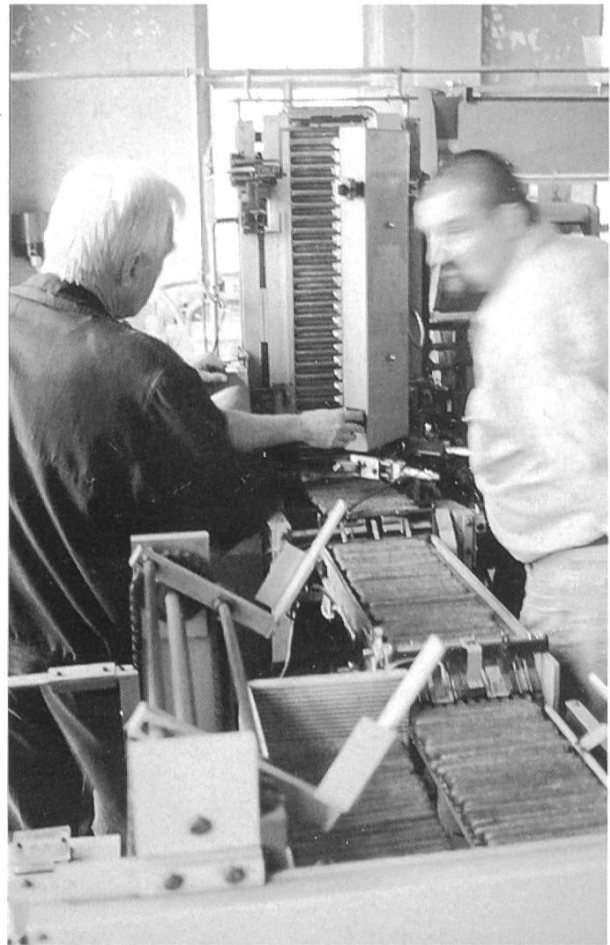
Maschinelle Herstellung von Stumpen bei Wuhrmann in Rheinfelden. (Foto: D. Wunderlin, 2000)
