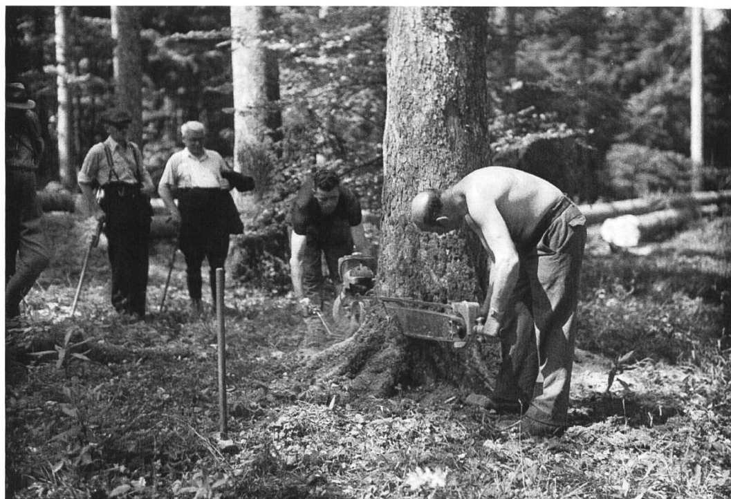
Abb. 06-4: 1948 Gelterkin- den, Arbeit an der 2-Mann- Motorsäge.
