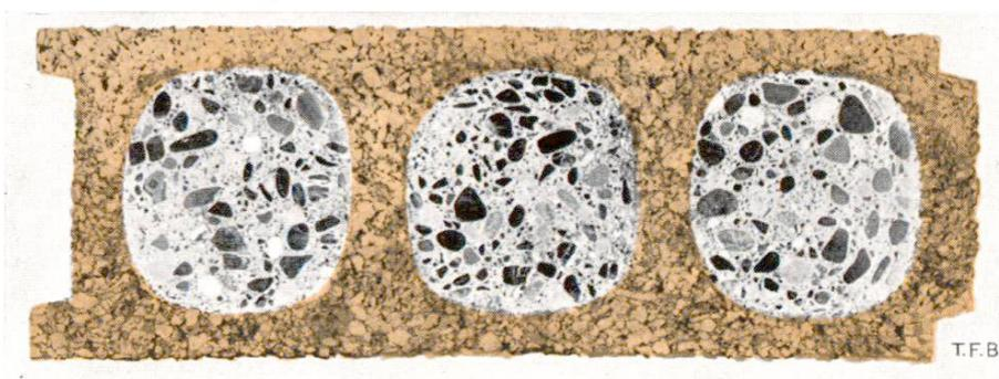
Fig. 1 Section d'une paroi en béton-liège
