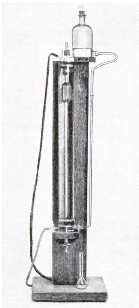
**Fig. 2 Détermination du poids spécifique du ciment.** Sur une quantité pesée de ciment (p. ex. 50 ou 100 grammes), on verse une quantité déterminée de pétrole. De l'augmentation de volume, on déduit le volume du ciment seul sans pores.
