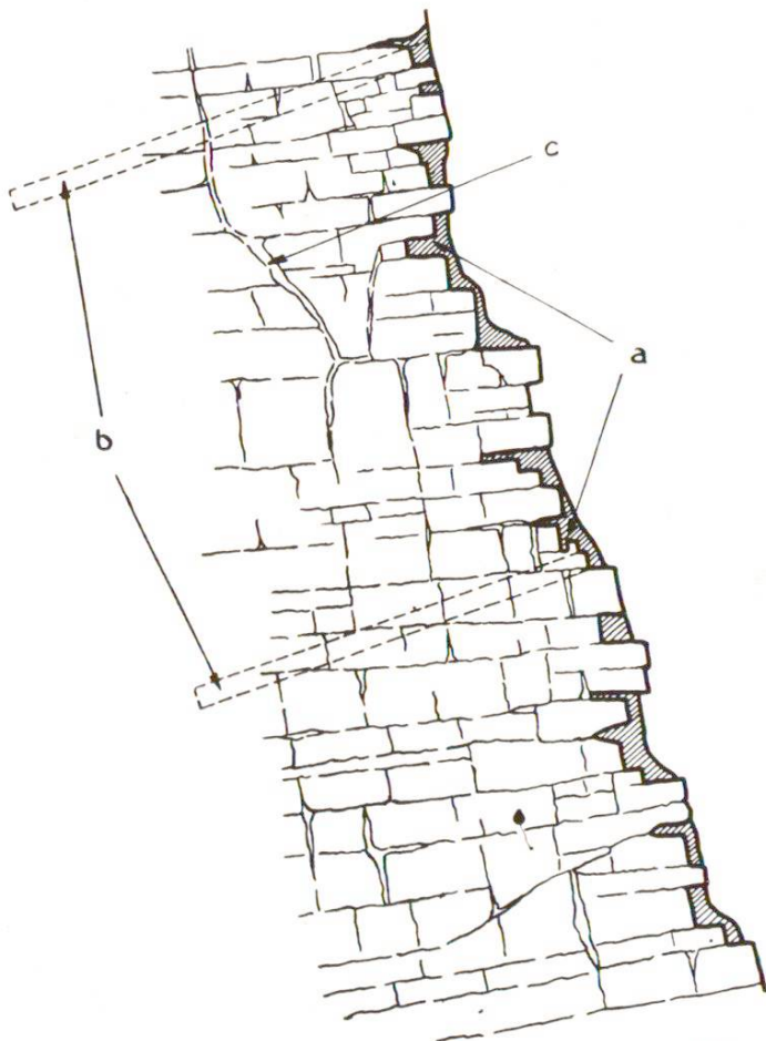
Fig. 3 Consolidation d'une raide paroi de rocher
