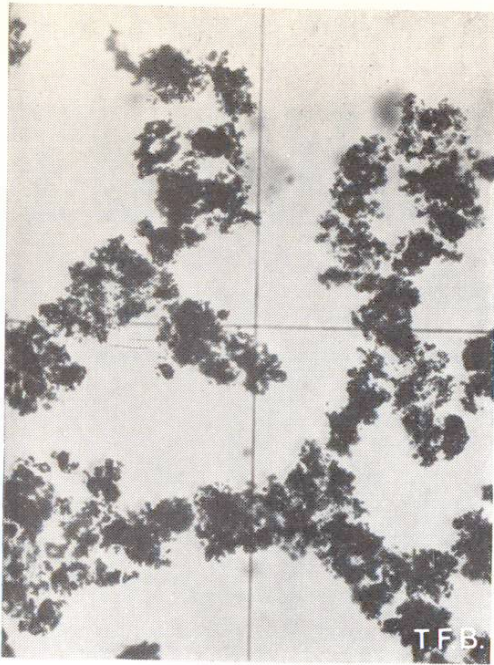
Fig. 1 Le pouvoir liant du ciment se manifeste après peu de temps, même dans un mélange très dilué. Les grains de ciment tendent à se réunir en formant des chaînes. (Fort grossissement)
