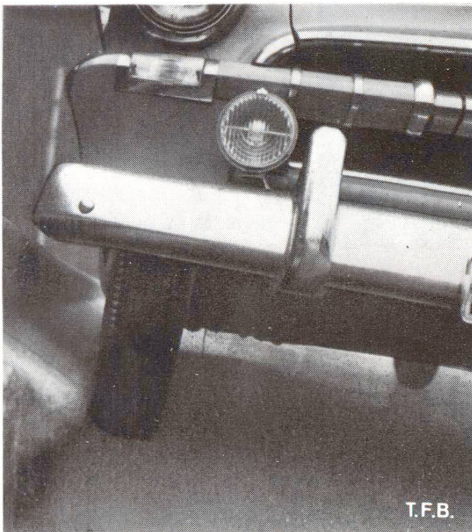
Fig. 7 Guidage d'un véhicule par une bordure de sécurité.
