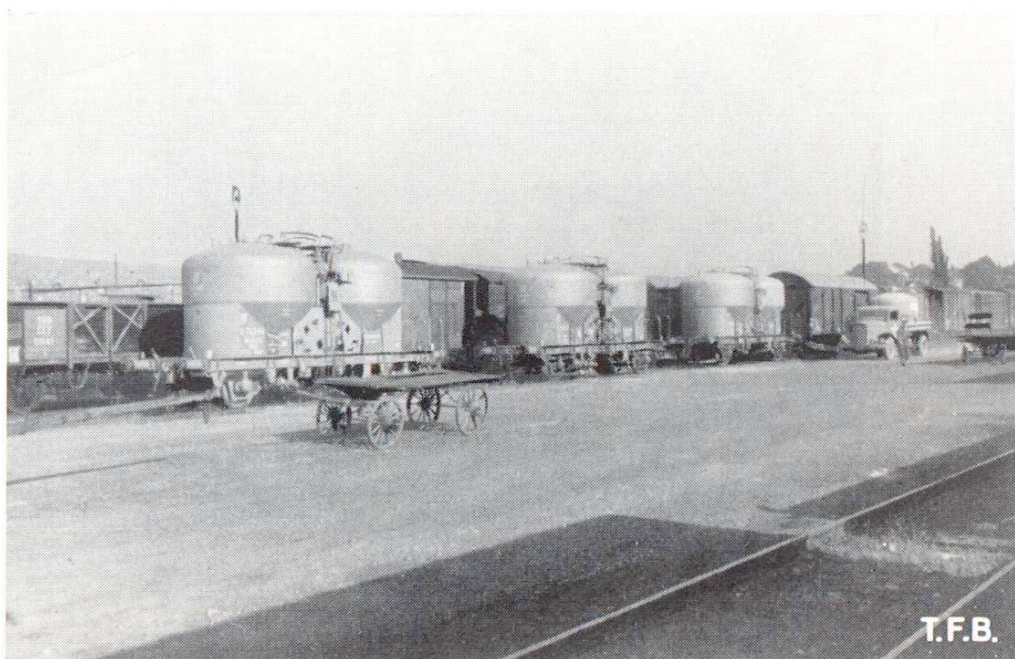
Fig. 1 Transbordement de ciment pour silos en gare de Zurich. Trois wagons des CFF contenant chacun 2 \times 13 t. de ciment portland
