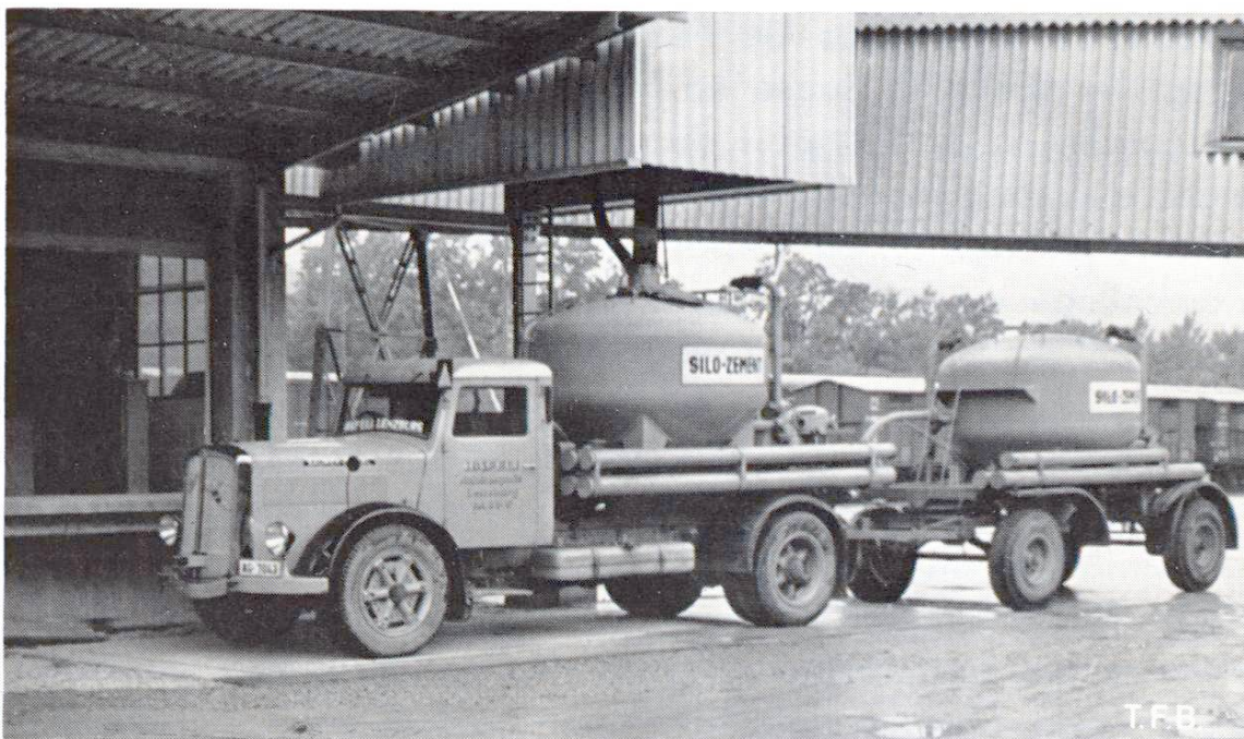
Fig. 5 Chargement de ciment en vrac sur camion placé sur pont-basculé
