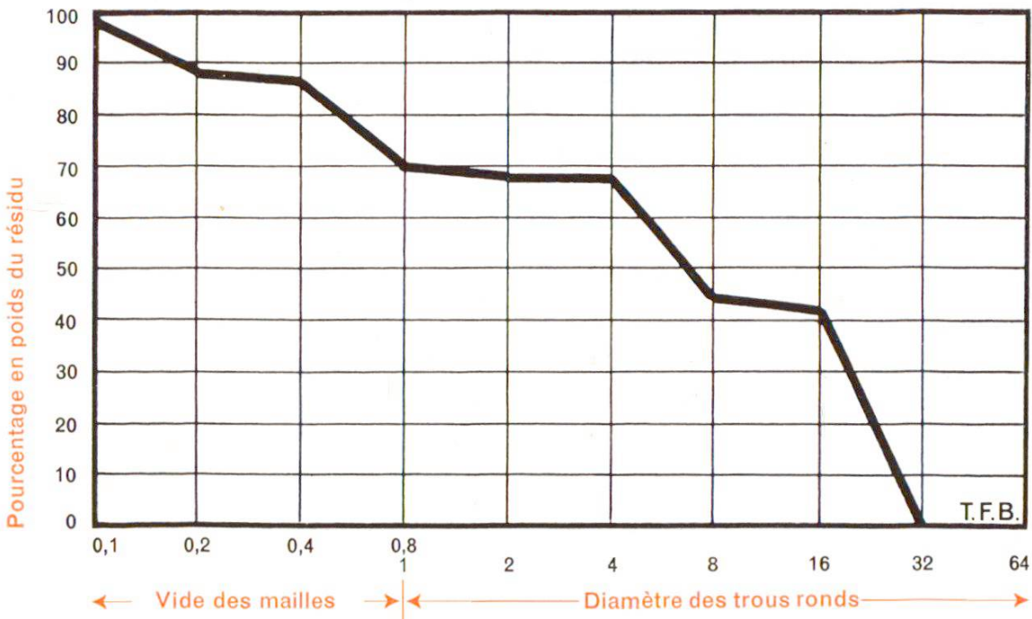
Fig. 4 Composition granulométrique discontinue, dans laquelle 3 groupes de grains sont absents.
