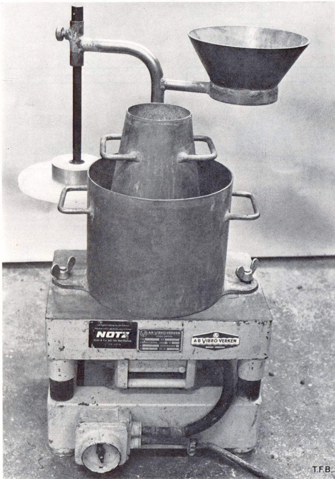
Fig. 7 Appareil Vébé Récipient cylindrique fixé sur table vibrante. A l'intérieur le moule pour façonner l'échantillon de béton. En arrière, guidé par un axe vertical, un support pivotant l'entonnoir de remplissage ou la plaque transparente.
