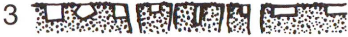
Fig. 2 La teinte initiale de la pâte de ciment est due au gris du gel et au blanc des petits cristaux de chaux qui affleurent la surface. Elle dépend du facteur eau:ciment, étant d'autant plus claire que ce dernier est plus grand.
