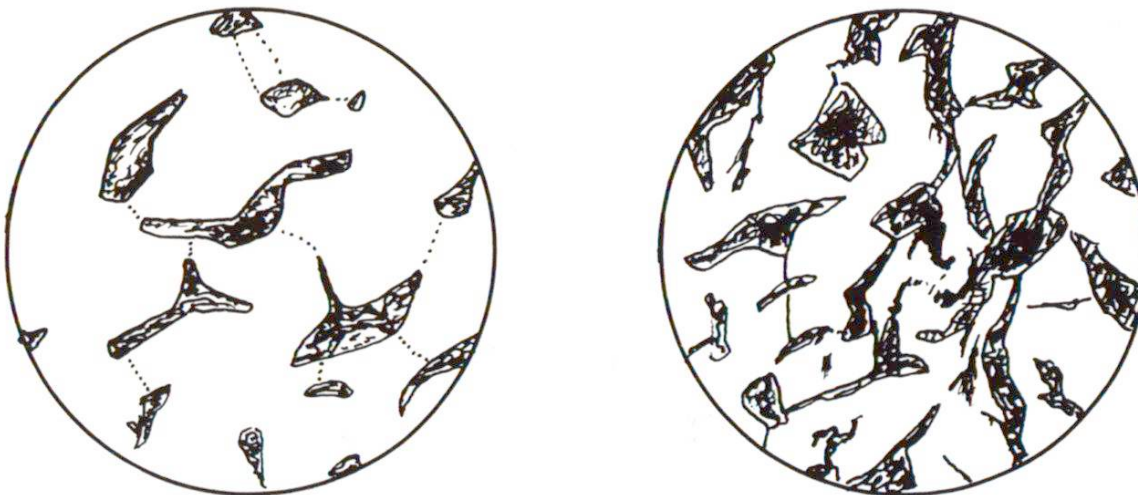
Fig. 1 Représentation schématique des pores de la pâte de ciment (diamètre du dessin env. 0.005 mm). A gauche: e/c 0.45, teneur en pores capillaires env. 10 %. Les vides ne sont reliés entre eux que par les pores du gel (en pointillé). A droite: e/c 0.8, teneur en pores capillaires env. 40 %. Les vides forment un réseau continu.
