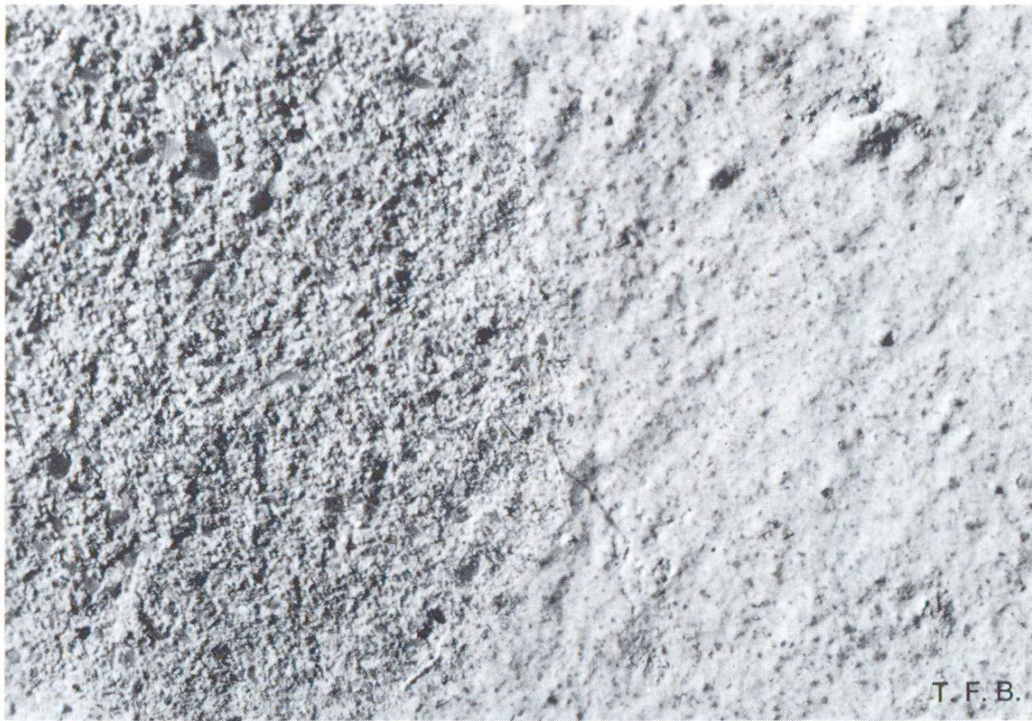
Fig. 2 La photo montre, à droite, une couche presque continue de dépôts de chaux qui, à gauche, a été dissoute à l'acide chlorhydrique. On constate la contribution des différents composants à la formation de la teinte générale. La rugosité de surface a aussi une influence en raison du jeu des ombres et des lumières qu'elle provoque.
