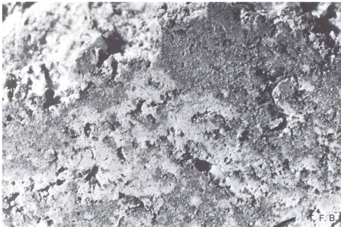
Fig. 1 Surface d'un béton à coffrage lisse vue avec grossissement. On remarque une structure très hétérogène: Pâte de ciment vitreuse de différentes teintes en raison de modifications locales de la teneur en eau – Grains de sable – Restes de ciment non hydraté – Petits agglomérats de chaux excrétée. Sous forme de points noirs, les gros pores contribuent aussi à la teinte grise. La largeur de la photo correspond à une dimension réelle d'env. 10 mm.
