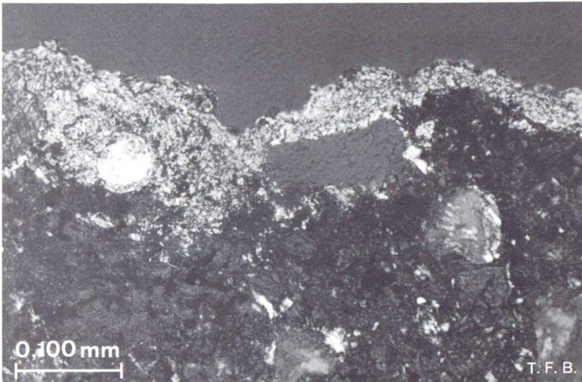
Fig. 1b Début de carbonatation à la surface d'un béton (vu au microscope). La couche de calcite a une épaisseur de 50 à 150  $\mu\text{m}$ . A la lumière polarisée elle apparaît claire, alors que la pâte de ciment alcaline reste sombre.
