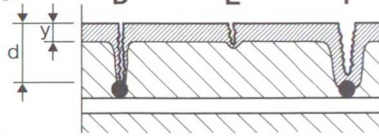
*Fissures A et D:* Armature en contact direct avec l'air. Corrosion indépendante de la carbonatation.
