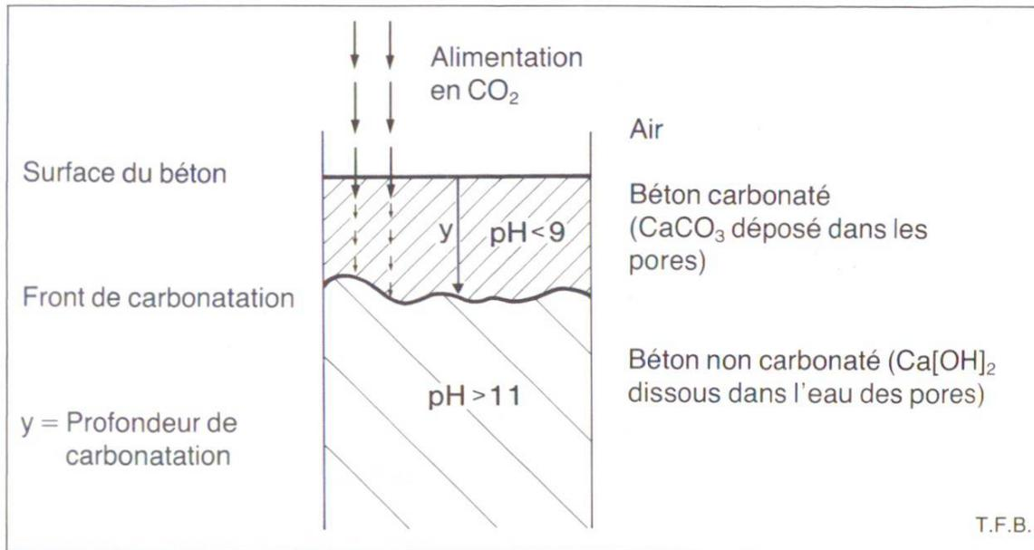
Fig. 1a Le  $\text{CO}_2$  de l'air pénètre par les pores de la pâte de ciment jusqu'au front de carbonatation. Il s'y forme de la calcite (carbonate de chaux) qui remplit partiellement les pores. L'hydrate de chaux est progressivement dissous en sorte que le front de carbonatation se déplace vers l'intérieur du béton.
