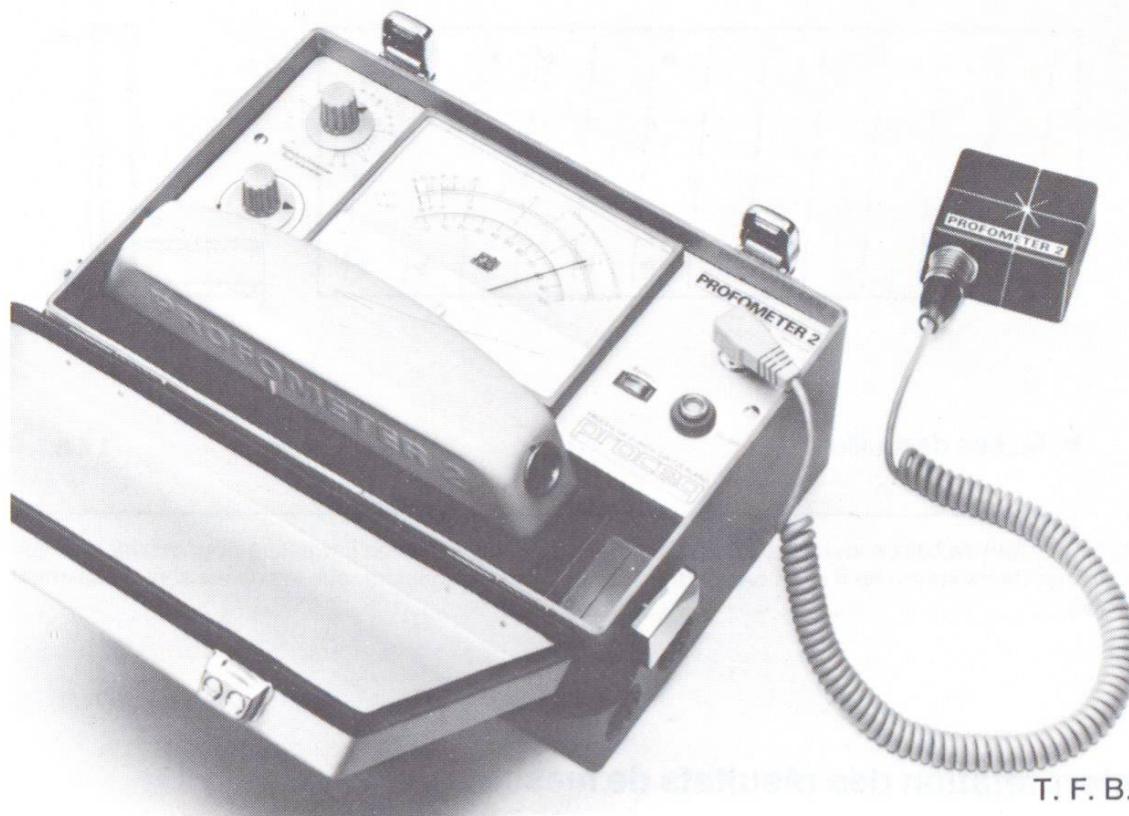
Fig. 1 Appareil électromagnétique de repérage de l'armature avec sa sonde ponctuelle. A gauche, les deux boutons, l'un pour le choix du diamètre des barres, l'autre pour la «mise à zéro».
