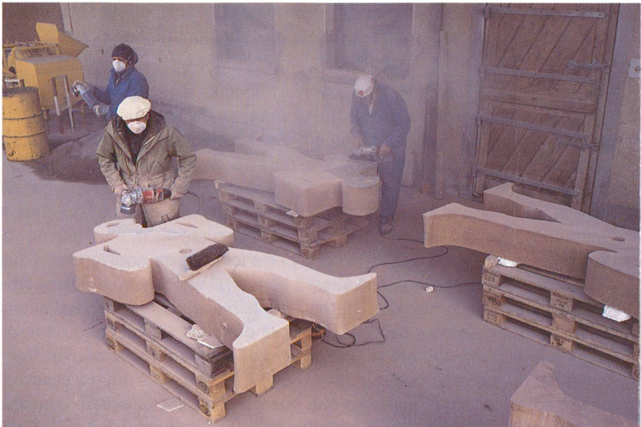
Préparation des sculptures démoulées. Meulage des arêtes et des surfaces
