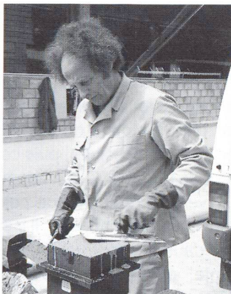
Talochage de la surface du cube terminé.
