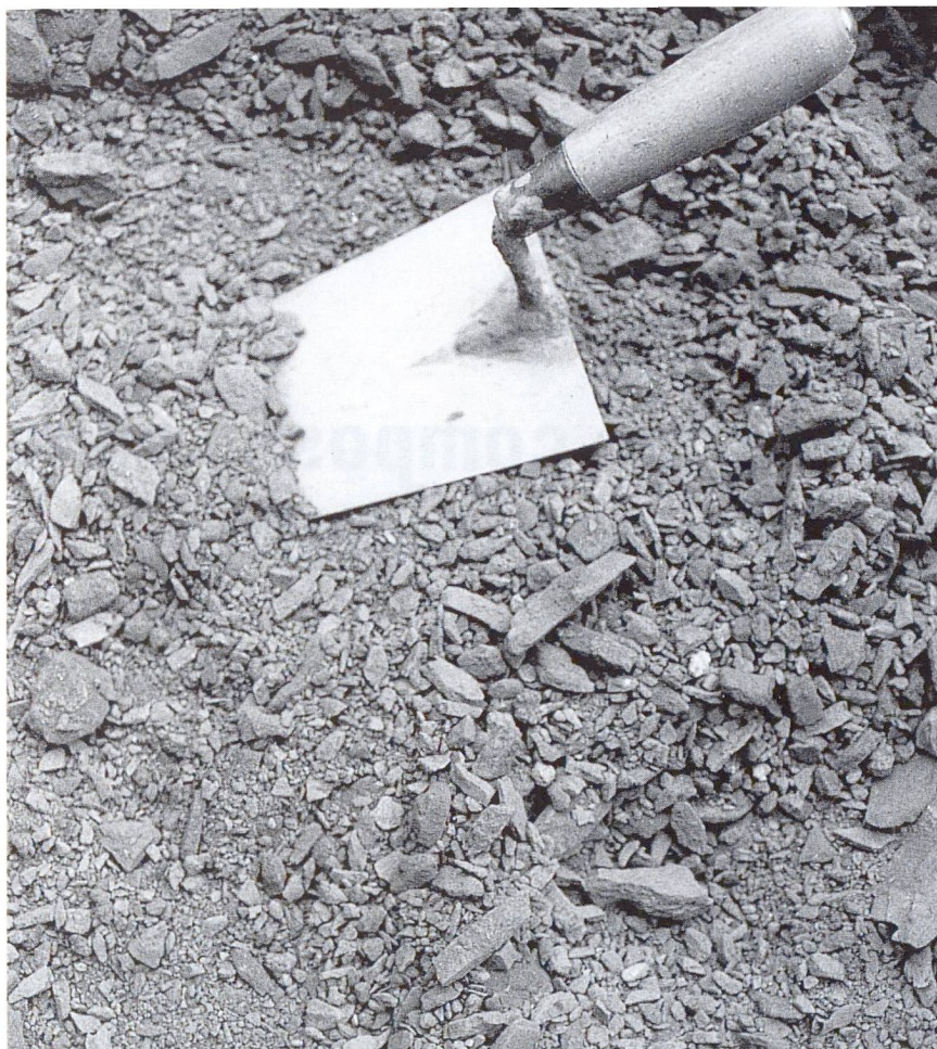
Matériaux extraits par tunnelier provenant du Kandertal (largeur de la truelle = 12 cm).
