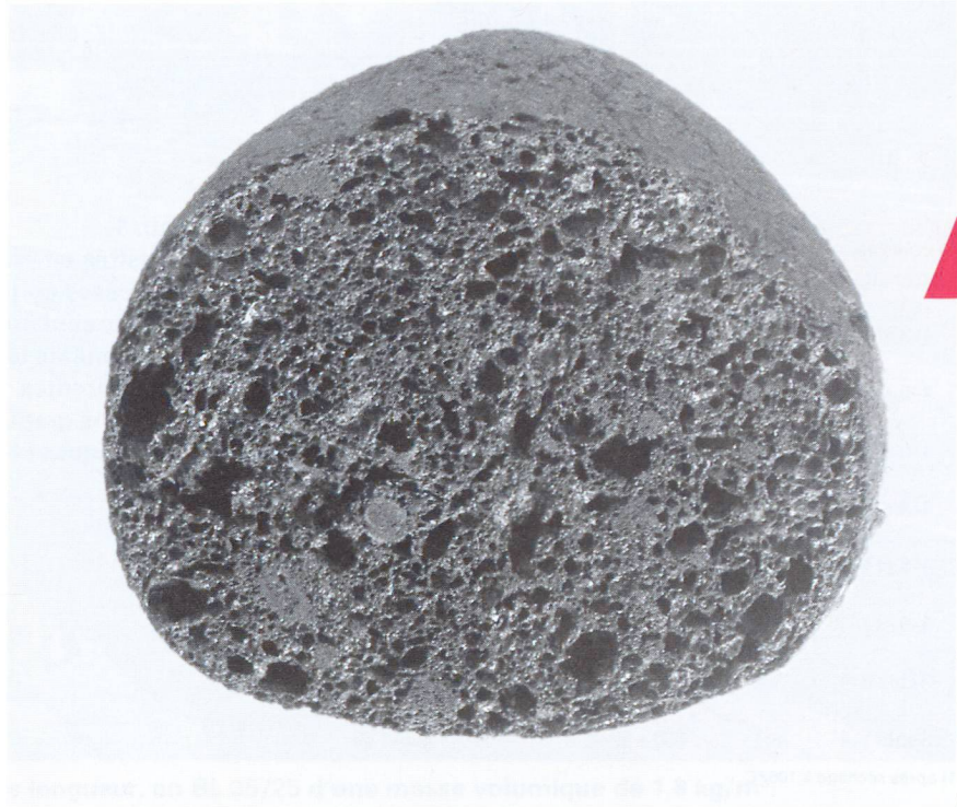
Coupe d'un grain d'argile expansée (diamètre env. 20 mm).
