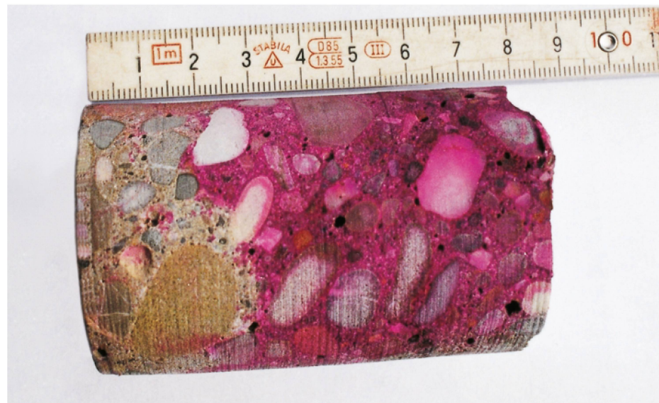
Vérification de la profondeur de carbonatation sur une carotte au moyen de phénolphtaléine.
