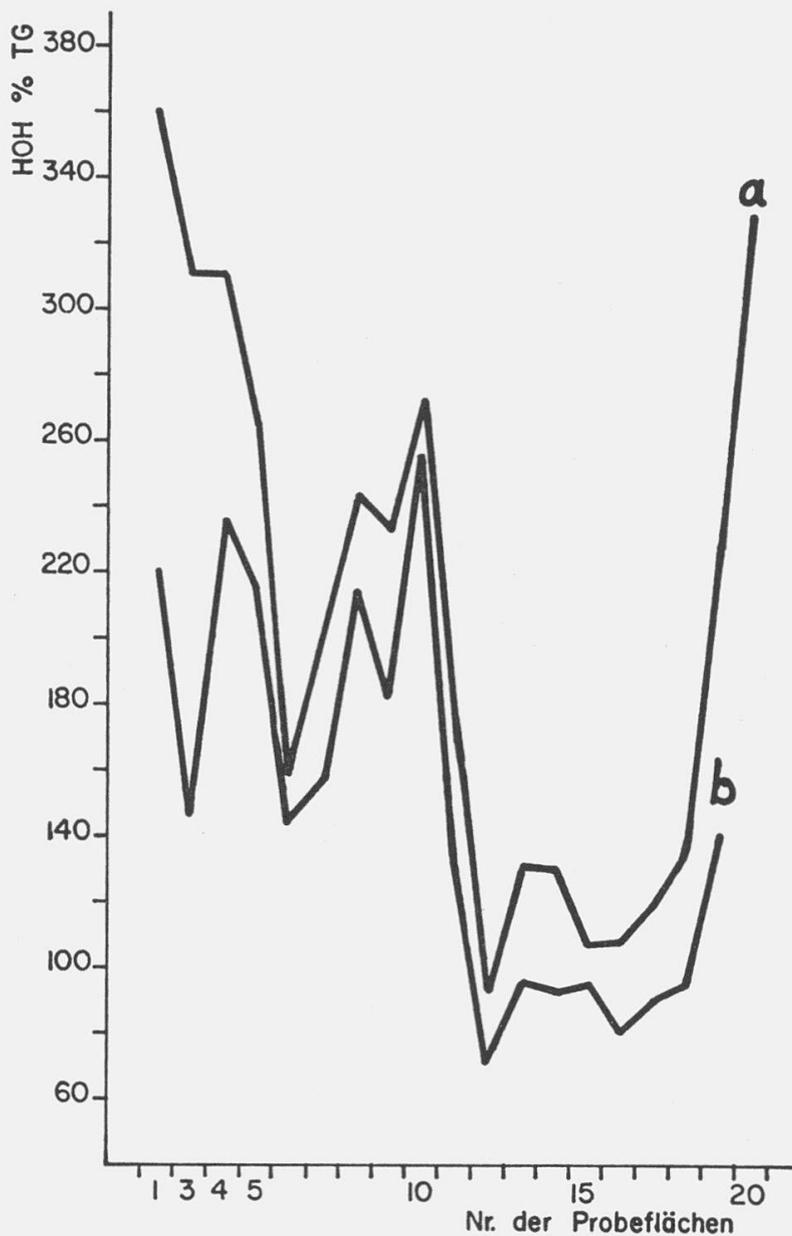
Abb. 5 Wassergehalt (HOH % TG) der Proben aus 0-5 cm (a) und 5-15 cm Tiefe (b).
