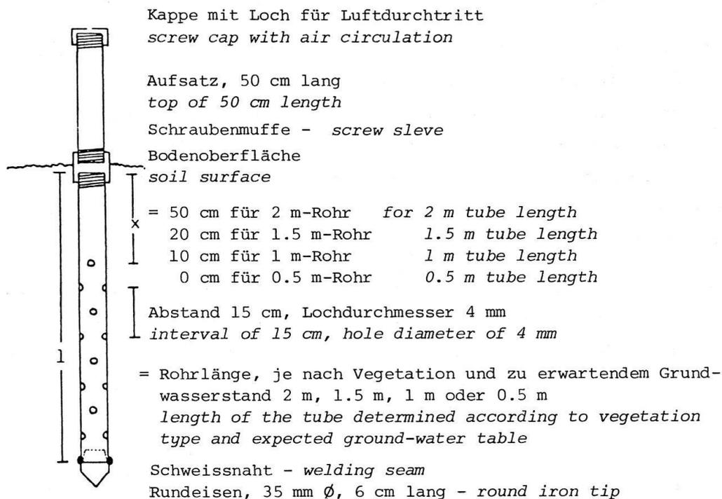
Abb. 1. Grundwasserbeobachtungsrohr (aus NäF 1980).
