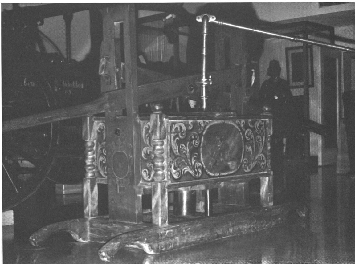
12. Schucke Schlagspritze aus dem Jahre 1707. Der Kolben wird mit zwei Druckstangen auf- und abwärts bewegt, das Wasser mit dem «Schwanenhals» (Wenderohr) auf das Feuer gelenkt. Die eine Schmalseite trägt den Spruch: «Man brucht Mich in der Noth / Dar Vor behüet Euch Gott 1707.» — Die Spritze stammt aus Ossigen, Kt. Zürich. Städtische Brandwache Zürich.
