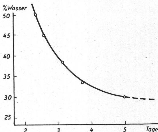
Unterhalb zirka 29 % können wir den Eintritt nicht mehr scharf erfassen. Wir sehen aber, daß die Kurve bei zirka 28 % asymptotisch wird. Bei weniger als 28 % Wasser ist also für das betreffende Material bei der Versuchstemperatur von 40° keine mikrobielle Gärung mehr zu erwarten.
