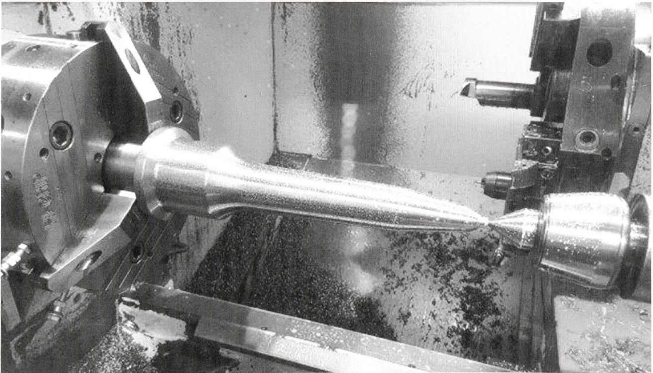
Abb. 13: Die Spindel wurde vollautomatisch und wassergekühlt in verschiedenen Stufen gedreht, hier das Ende der Spindelspitze.
