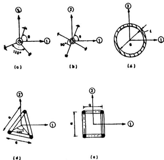
FIG. 1 TYPICAL GUY/TOWER CONFIGURATIONS
