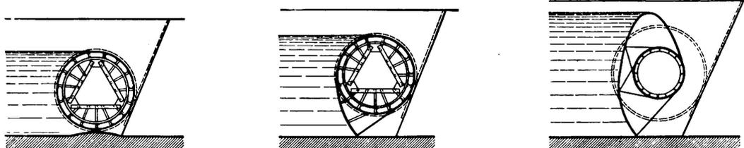
Walze mit reiner Zylinderform für eine im Verhältnis zur Lichtweite geringe Stauhöhe.
