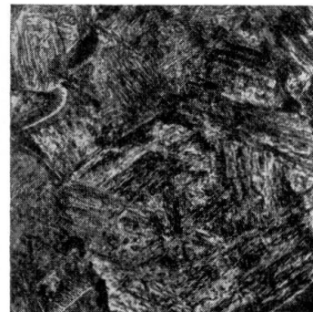
Temperatur: 50° C Martensit, wenig Troostit, Spuren Ferrit.
