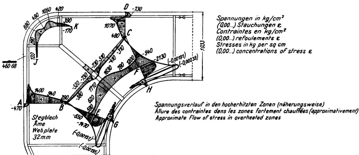
Fig. 12. Messung der Schweiß-Spannungen bei der Herstellung.
