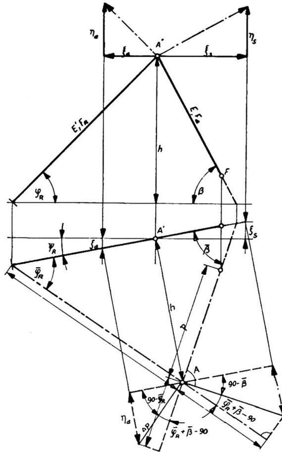
**Abb. 7.** Bestimmung der Verschiebungskomponenten für die Rückverankerung.
