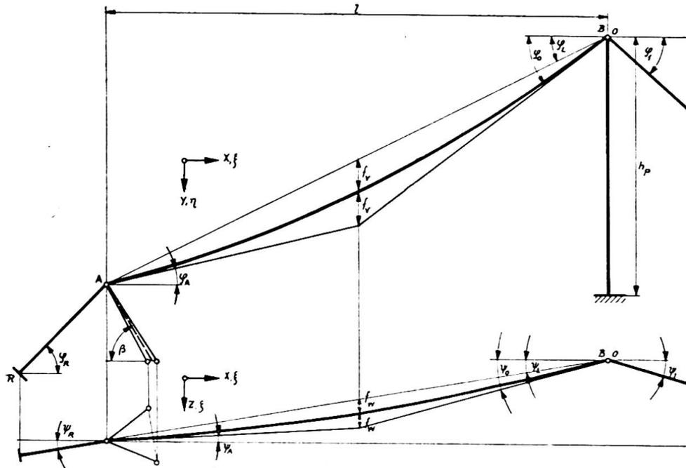
Abb. 6. Räumliche Seilführung der Aussenöffnung einer Hängebrücke bei Gleichlast.
