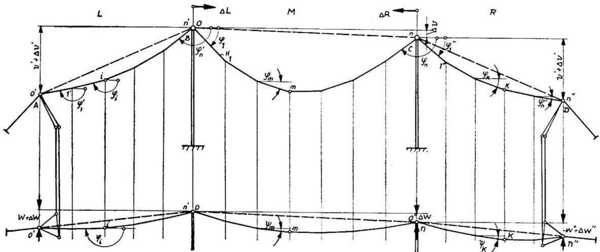
Abb. 4. Hängebrücke mit Aussenöffnung und räumlicher Seilführung.
