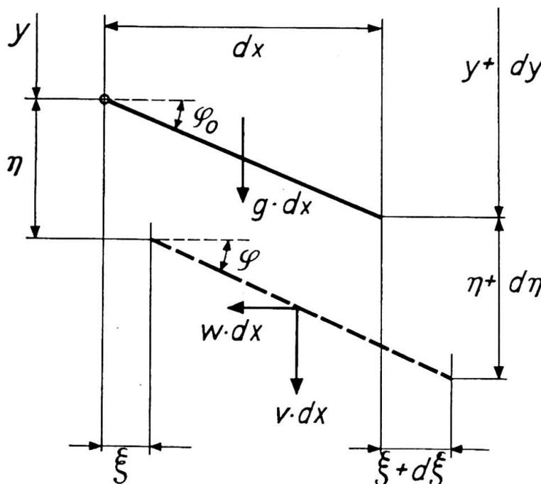
Ablenkungskräfte verändert werden, als auch darin, dass sich infolge der wagrechten Komponenten der Hängestangenkräfte der Kabelzug über die Spannweite ändert. Wir können diese beiden Einflüsse in einem zweiten Rechnungsgang durch Einführung einer Zusatzlast
