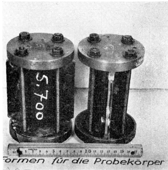
BILD 3. Formen für die Herstellung der Probekörper zur Feststellung der Frostbeständigkeit im Dilatometer
