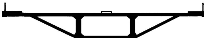
Fig. 43. Brücken-Querschnitt mit seitlichen dreieckigen Hohlkästen.
