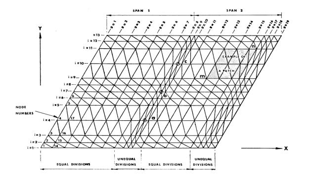
FIG 1 EXAMPLE OF DECK SPECIFICATION
