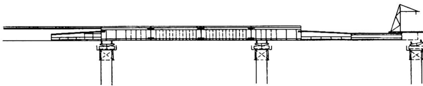
Bild 4. Vorschubgerüst mit Vorbaustütze
