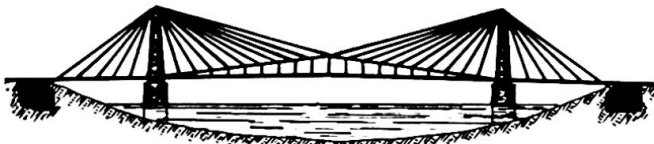
Bild 4: Schrägseilbrücke Bauart Gisclard- Anodin
