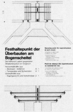
Koppelung an den Überbaustegenden durch Spannlieder
