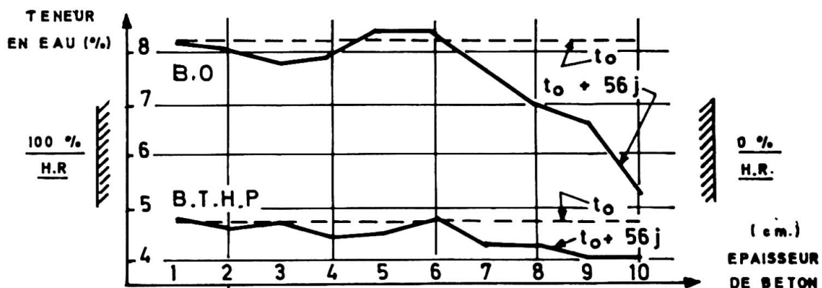
Figure 3: évolution de la teneur en eau dans des éprouvettes soumises au séchage [8].
